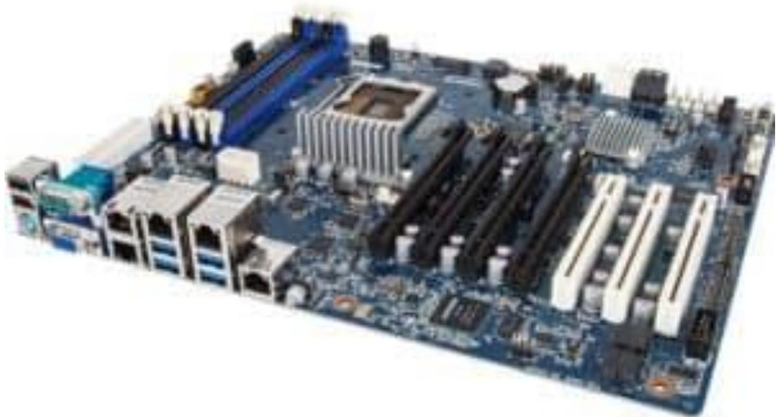
هي أشبه بالأرضية التي تعمل على وصل جميع مكونات الجهاز بعضها ببعض. فضلاً عن تنسيق العمليات و ترشيد سير البيانات. كما أنها تعمل على تزويد أعضاء الجهاز المختلفة بالطاقة. و هي توجد داخل ال case
