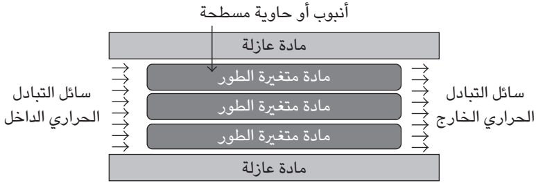
شكل ٦-١٢: تغليف مادة متغيرة الطور: مثال لمادة متغيرة الطور مغلقة في أغلفة مسطحة أو أنبوبية للتغلب على مشكلة الموصلية الحرارية المنخفضة للمواد المتغيرة الطور.
